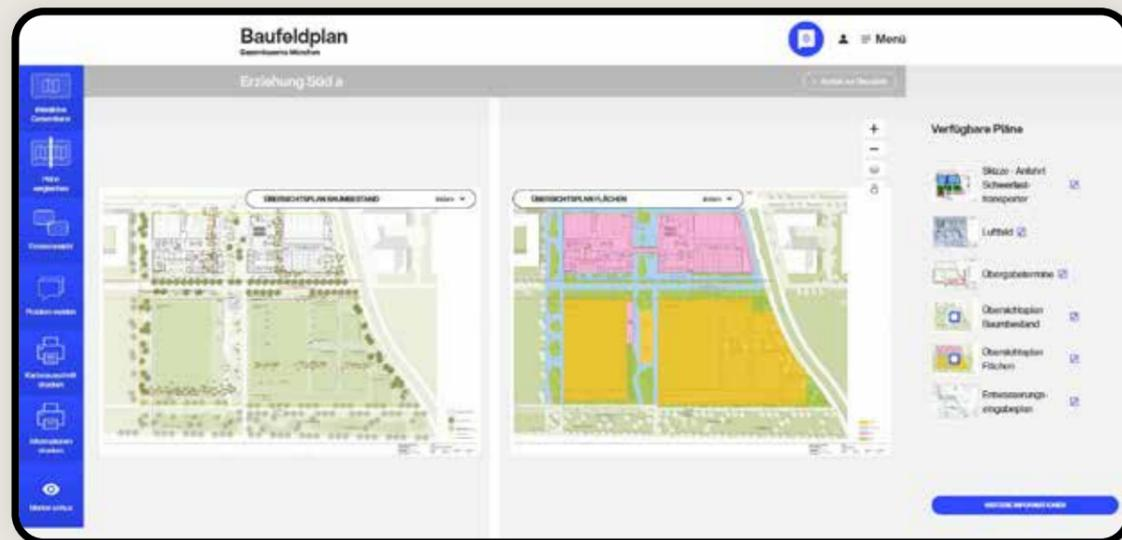
Bauplanung, Durchführung, Kommunikation und Dokumentation werden alle parallel durch das mit offenen Standards eigenentwickelte Geografische Informationssystem (GIS) gespeist bzw. gepflegt. Dies ermöglicht Effizienzgewinne in allen Bauphasen, sowie eine mögliche „Übergabe auf Knopfdruck“ an nachfolgende Eigentümer.
